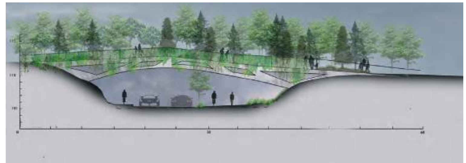
Snitt B-B', den nye overgangen over pilegrimsleden
